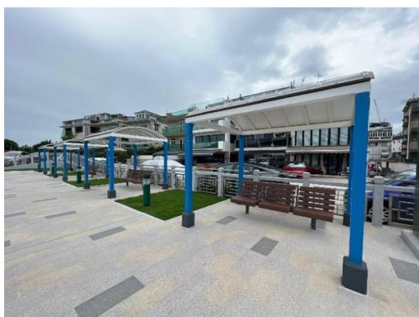
位於南區華林徑的休憩處(擴展部分)(上排)及大埔區井頭村的休憩處(下排)採用含有回收玻璃的鋪路磚，以及以循環再造塑膠木材條製成的長椅，並為照明裝置裝設了定時控制器和光線感應器。
